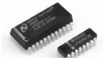
图 1.1.1-1 双排直插式（DIP）封装
